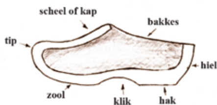
Klompdoorsnede met de benamingen van de onderscheidene delen.
