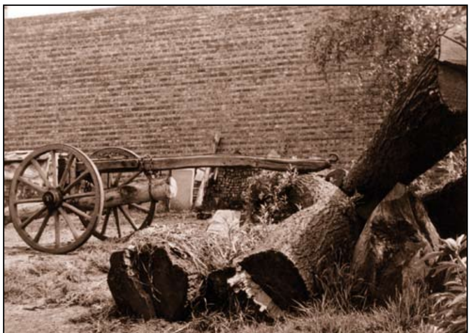
Een "mallejan" ofte "euts": een speciaal voertuig voor het transport van boomstammen. Met het verdwijnen van het blokkenmakersambacht verdween ook dit transportmiddel.
