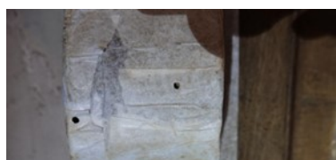
Na amper één week verschenen er uitvliegopeningen in het detectiepapier
